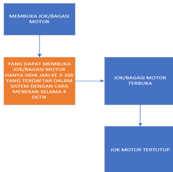
Gambar 7 Proses membuka jok atau bagasi motor
