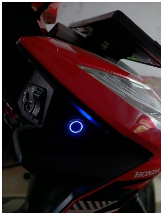
Gambar 10 Alat keamanan motor sidik jari yang sudah di pasang di motor
